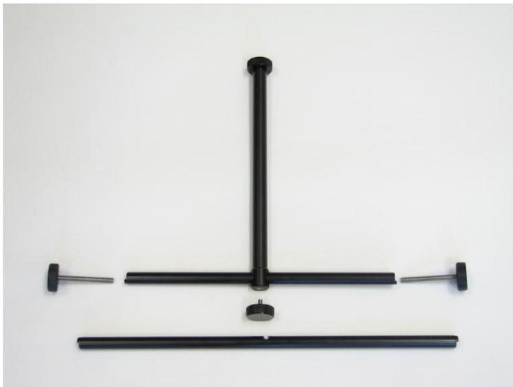
Togliere le viti di contrappeso sulla barra che si sta utilizzando e metterle da parte. Togliere la vite della barra orizzontale e metterla da parte. Sfilare la barra orizzontale. Inserire la nuova barra ed allineare i fori esistenti sul giunto a T. Riavvitare la vite della barra orizzontale e stringerla adeguatamente. Rimontare le viti di contrappeso sulla nuova barra.
