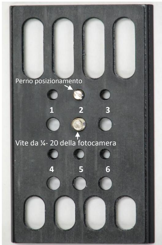
Posizionare la vite da  $\frac{1}{4}$ -20 della fotocamera nel foro che appare corrispondere al centro di gravità della fotocamera appena sopra lo snodo. Oppure, iniziare dal foro n. 2 al centro della piastra e controllare il bilanciamento. Il perno di posizionamento si avvita nel foro corrispondente.
